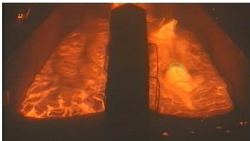
Figure 6.3-1 : Etallement de corium prototypique sur des veines en céramique (à gauche) et en béton (à droite) [Essai VULCANO VE-U7]
