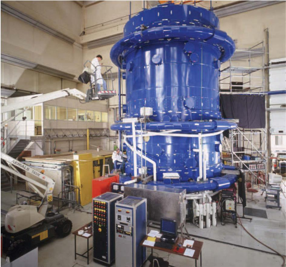
Figure 5.22. Image de l'installation MISTRA. Essais de sismologie sur la table vibrante de l'installation MISTRA (bâtiment 452) [référence PAR-20050629-003, crédit : A. Gonin/CEA].
