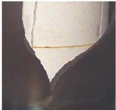
**Figure 5.9.** Aperçu de l'éclatement du tube n° 2 en acier 316L lors d'une rampe de température de  $0,05 \text{ }^\circ\text{C/s}$  et pour une contrainte de membrane de 107 MPa.
