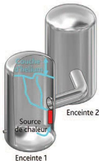
Figure 5.19. Schéma de l'installation PANDA.
