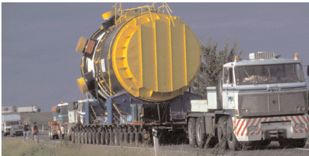
△ Transport de la cuve du réacteur de Civaux 2.
