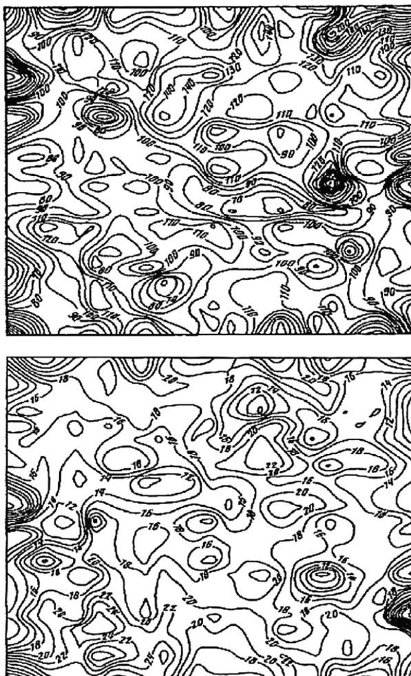
**Figure 1.15.** Concentration en taches de  $\text{Cs-137}$  (au-dessus) et de  $\text{Ce-144}$  (en-dessous) dans la zone forestière située dans le périmètre des 30 km autour de Tchernobyl – Échelle 1/600<sup>e</sup> [Tscheglov, 1999]
