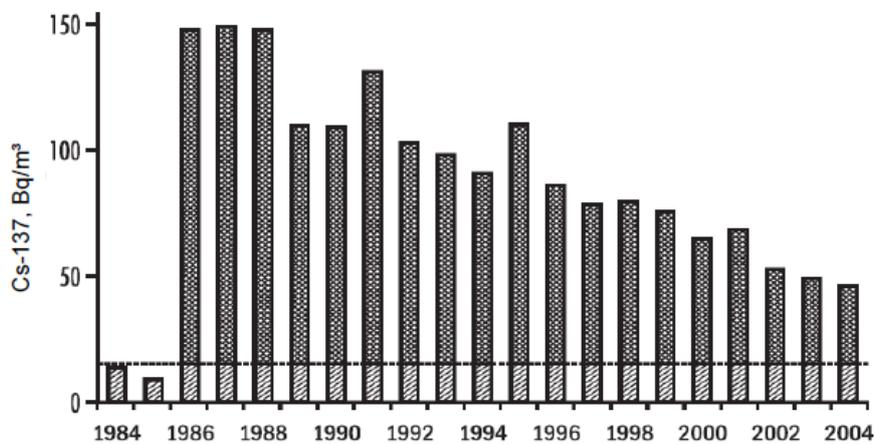
**Figure 8.2.** Moyenne annuelle de concentration du Cs-137 (Bq/m<sup>3</sup>) dans les eaux de surface de l'est et de l'ouest du Gotland (prélèvements à une profondeur ≤10 m) de 1984 à 2004. La ligne en pointillé indique le taux moyen avant Tchernobyl (1984-1985) [HELCOM, 2006]
