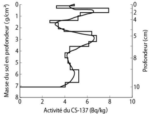
**Figure 1.14.** Activité du Cs-137 dans les sédiments du lac Dabusupao (nord-est de la Chine). Le pic de radioactivité des sédiments à une profondeur d'environ 6 centimètres est associé à des essais nucléaires dans l'atmosphère et les pics à une profondeur d'un à 2 centimètres aux retombées de Tchernobyl (Xiang, 1998)
