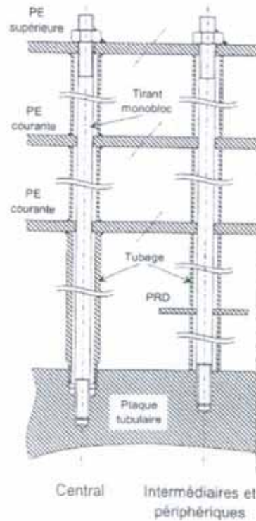
Figure 3: Schéma des tirants monoblocs d'un GV de type 51A
