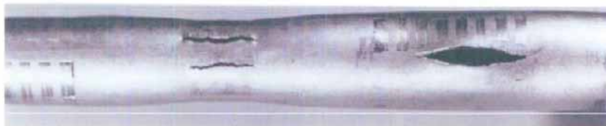
Figure 41: Essai d'éclatement EDF - Mode de rupture d'un tube présentant des fissures longitudinales au droit d'une plaque entretoise
