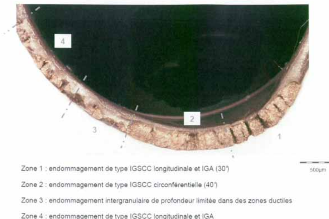
Figure 28: Tronçon L16C20-E2, bilan de l'endommagement d'après diverses observations
