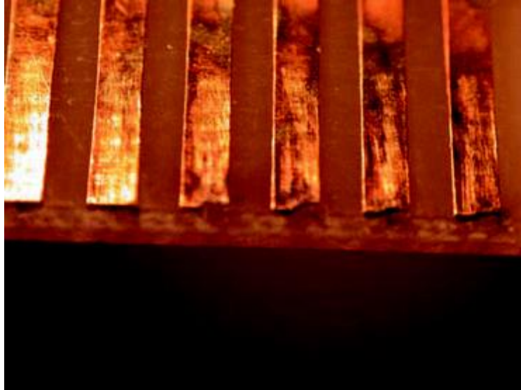
Figure 9 - Connecteurs de cartes électroniques dégradés par la corrosion et par des arcs électriques
